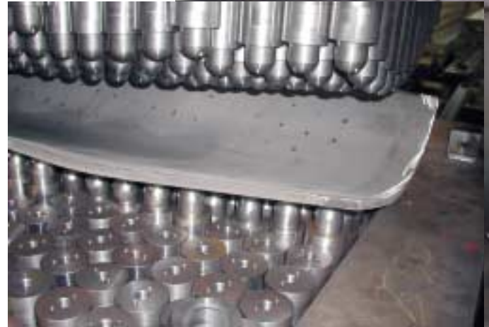
Verarbeiten lassen sich Bleche unterschiedlicher Materialgüte vom normalen Baustahl bis zum hochwertigen Edelstahl und bis zu einer Materialstärke von 25 Millimeter.
