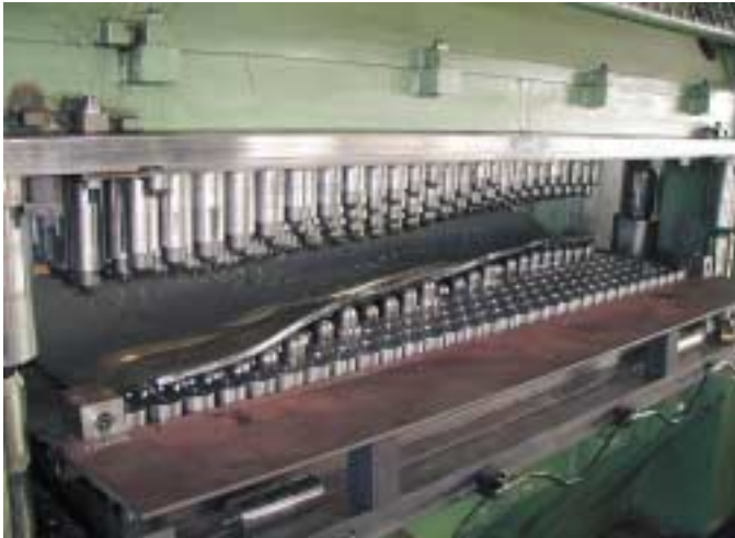
Im ersten Einsatzfall werden 16 mm dicke Bleche mit einer Toleranz von \pm 1 bis 2 Millimeter verformt.
